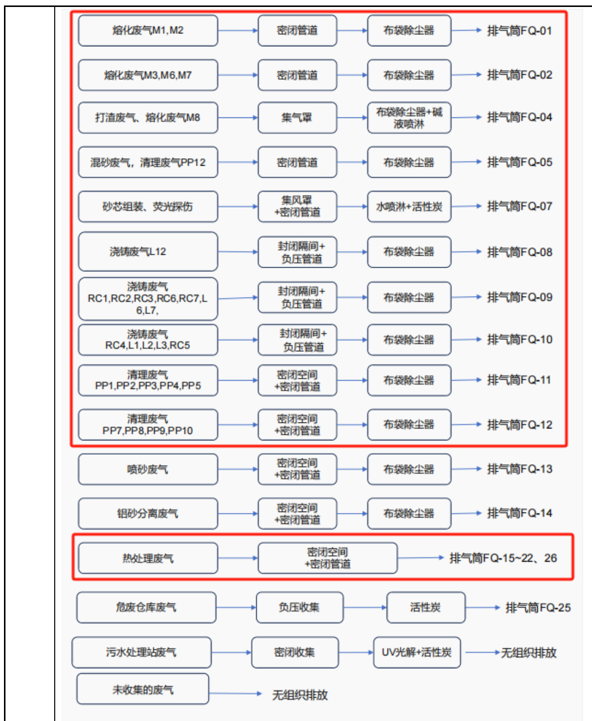
图 4-4 全厂废气处理流程图（红色框内为本次技改项目涉及排气筒）
