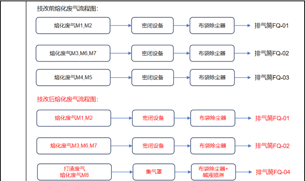
图 4-2 熔化废气技改前后工艺流程图
